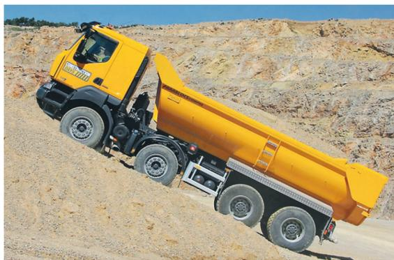
Система OptiTrack позволяет практически без пробуксовки карабкаться по скальным склонам
