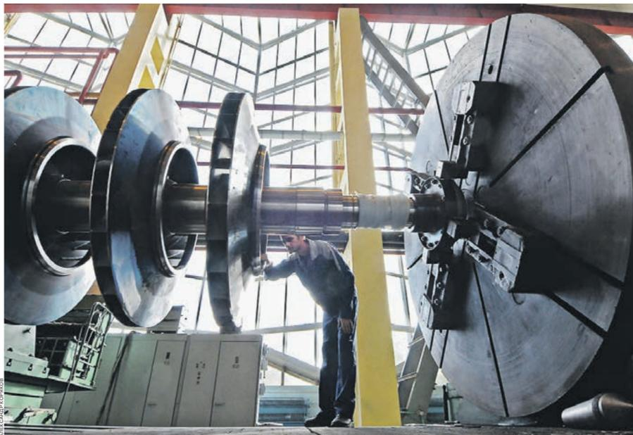
Сборка турбины на «Невском заводе».
