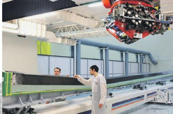
Специалисты ЗАО «АэроКомпозит-Ульяновск» (OAK) в рамках проекта MC-21 уже приступили к изготовлению полноразмерных деталей для удлиненного крыла из композитных материалов, снижающих массу самолета
