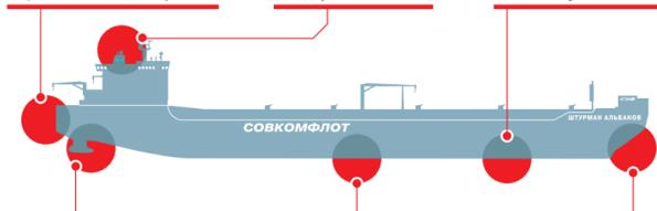
Пропульсивная установка из двух винторулевых колонок типа Azipod со совокупной мощностью 22 МВт обеспечивает высокую ледопробиваемость и маневренность
